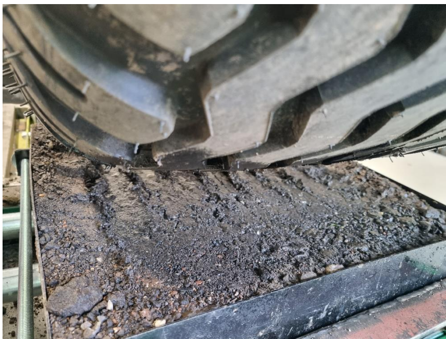
Rys. 18. Wykorzystane do badań utwardzone podłoże gruntowe w stanie suchym (góra) i mokrym (dół) w trakcie eksperymentu
