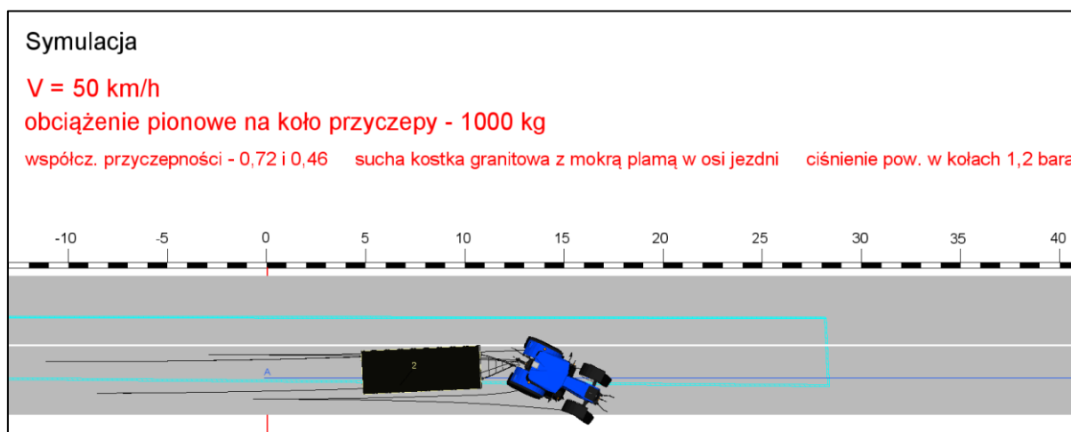
Rysunek 59. Pozycja końcowa symulacji na nawierzchni z kostki granitowej przy prędkości początkowej hamowania 50 km/h
