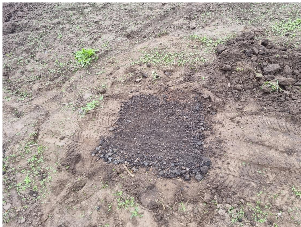
Rys. 17. Widok zakopanej w polu skrzynki badawczej podczas procesu ubijania nawierzchni gruntowej
