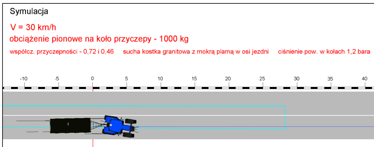
Rysunek 57. Pozycja końcowa symulacji na nawierzchni z kostki granitowej przy prędkości początkowej hamowania 30 km/h.
