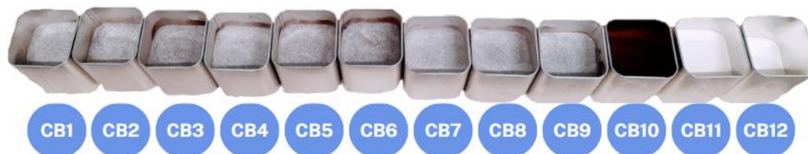
Rys.7. Chemiczne mieszanki biomasy umieszczone w metalowych boksach
