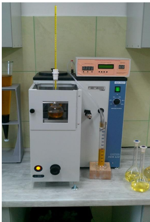
Rys. 16. Stanowisko badawcze wyposażone w destylarkę firmy Herzog HAD 620/1 Źródło: opracowanie własne
