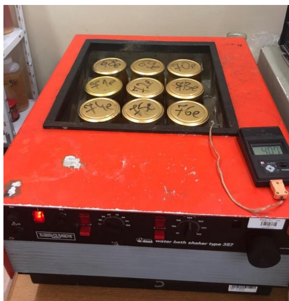
Rys. 10. Reaktory z mieszaniną oleju, katalizatora oraz alkoholu umieszczone w łaźni wodnej Źródło: opracowanie własne
