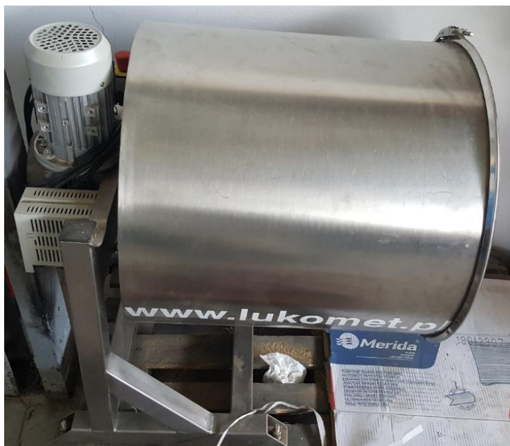
Rys. 23. Urządzenie do określania wytrzymałości mechanicznej brykietu, prod. Łukomet Źródło: opracowanie własne
