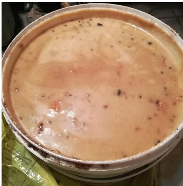
Rys. 7. Zużyta frytura palmowa przed oczyszczeniem – zawierająca spożywcze odpady stałe Źródło: opracowanie własne
