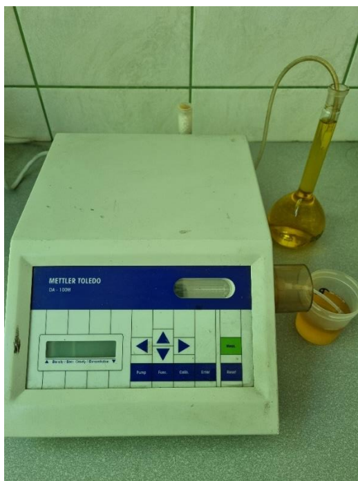
Rys. 13. Stanowisko do wyznaczania gęstości paliw wyposażone w gęstościomierz firmy Mettler Toledo model DA-100M Źródło: opracowanie własne
