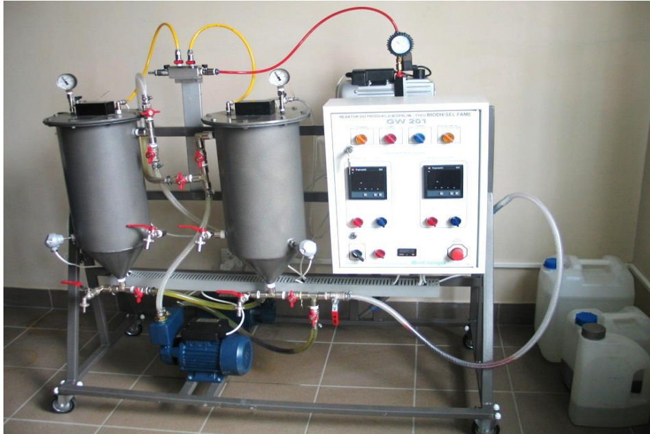
Rys. 11. Stanowisko badawcze do wytwarzania biopaliw w skali półprzemysłowej Źródło: opracowanie własne
