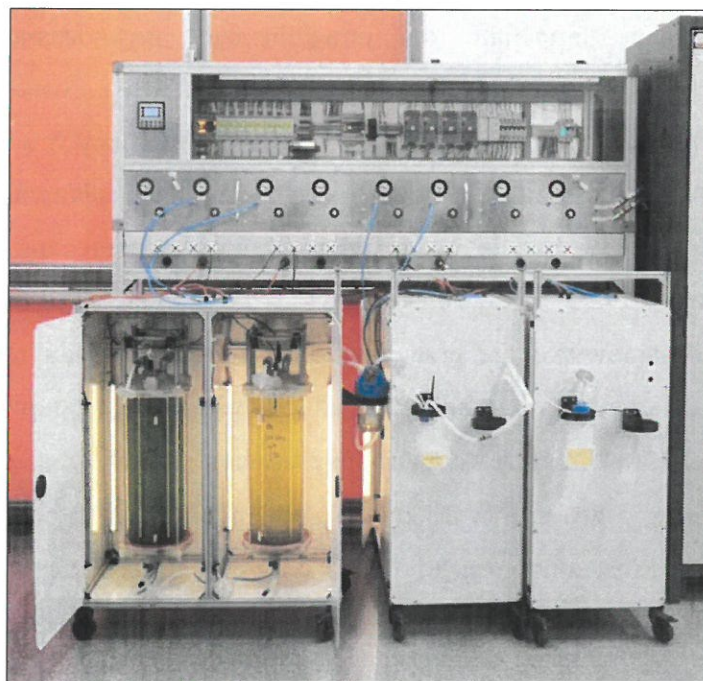
Rysunek 3. Stanowisko ostatniego etapu namnażania inokulum mikroalg Haematococcus pluvialis
