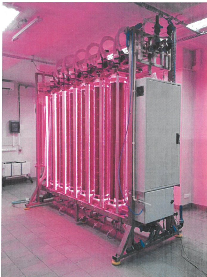
Rysunek 4. Moduł dwunastu fotobioreaktorów typu airlift do biosyntezy astaksantyny w skali półtechnicznej
