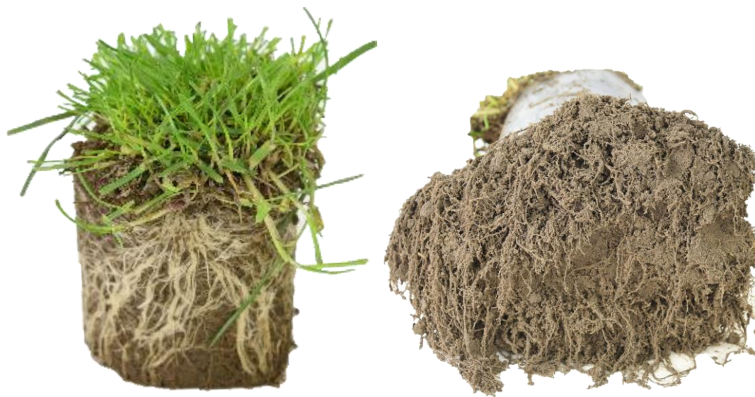
Rysunek 4. System korzeniowy traw, który rozwinął się na włókninie igłowanej, 100% wełna (BB)
