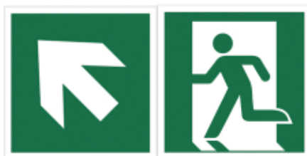
a) kierunek do wyjścia drogi ewakuacyjnej schodami w lewo i w górę
