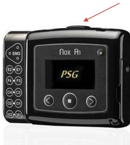
Rycina 7. Mikrofon wbudowany w urządzenie Nox A1 – oznaczony strzałką Źródło: https://www.medi-shop.gr/en/sleep-diagnostic-systems/nox-a1-sleep-diagnostic-system (w modyf. A. Witek)
